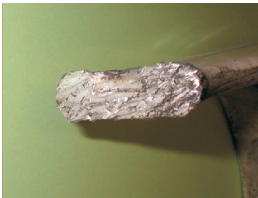
Foto 2. Detalle de la superficie de fractura en la horquilla
