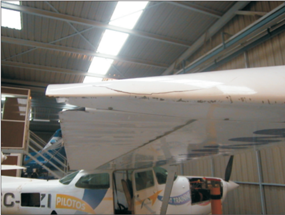
Foto 2. Daños en la punta de ala
