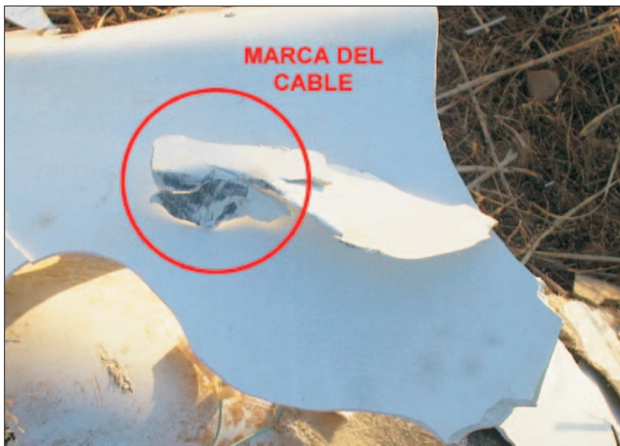
Figura 5. Marcas dejadas por el cable en el borde marginal del plano izquierdo
