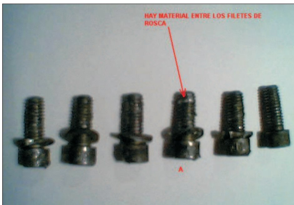
Figura 5. Tornillos que unen la semillanta interior y el disco de frenos con el buje
