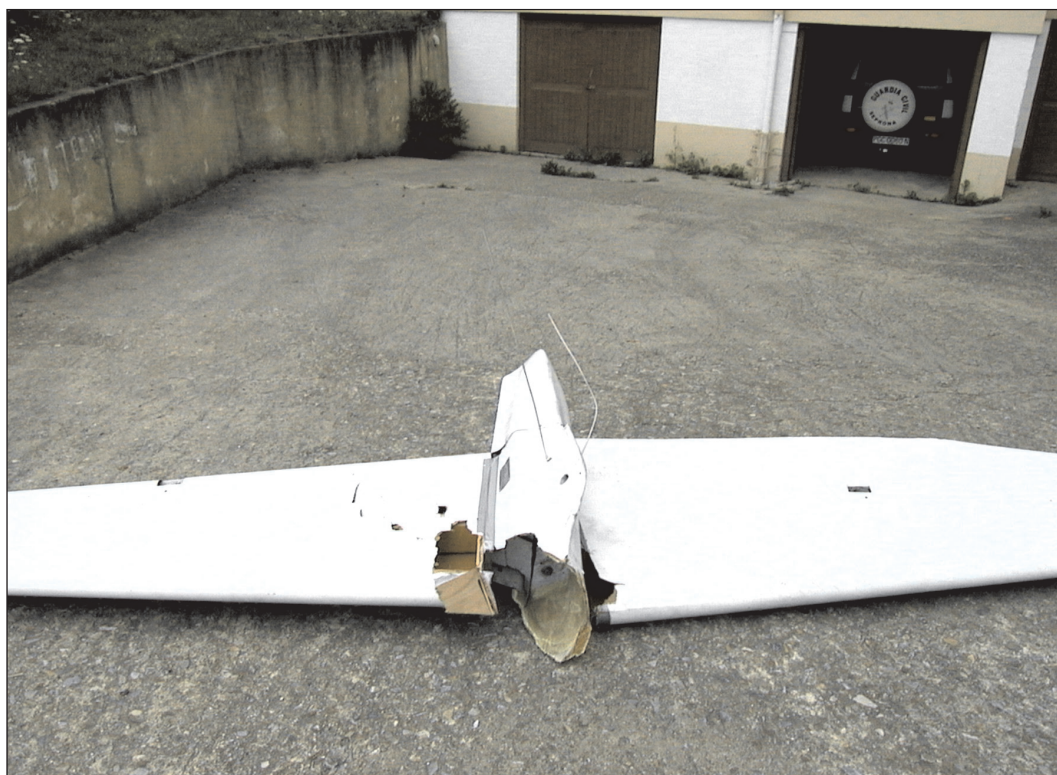
Figura B-1. Restos de estabilizadores
