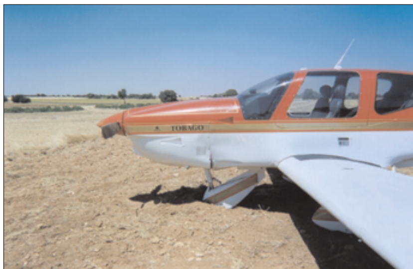
Fotografía 2. Daños en el tren de morro.
