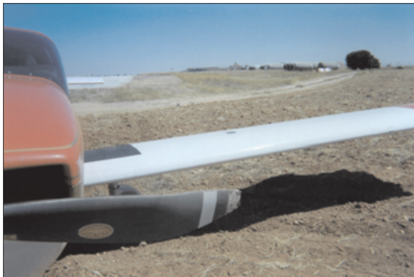
Fotografía 1. Daños en la hélice.
