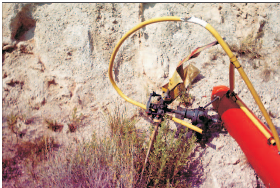
Figura 3. Daños del protector del rotor de cola y rotor de cola
