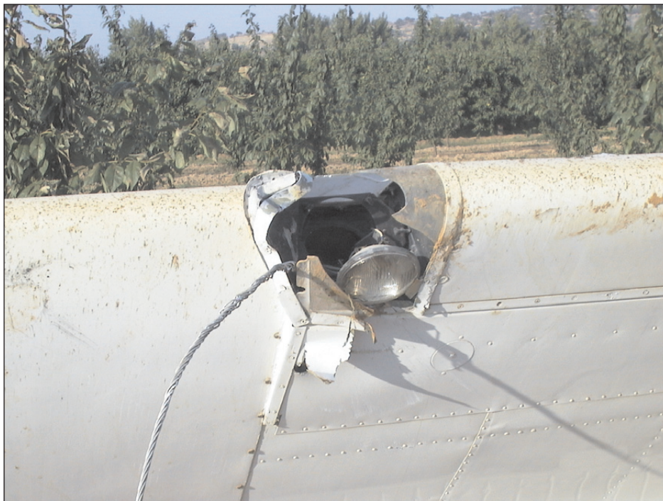
Foto 2. Detalle del cable trabado en el plano derecho
