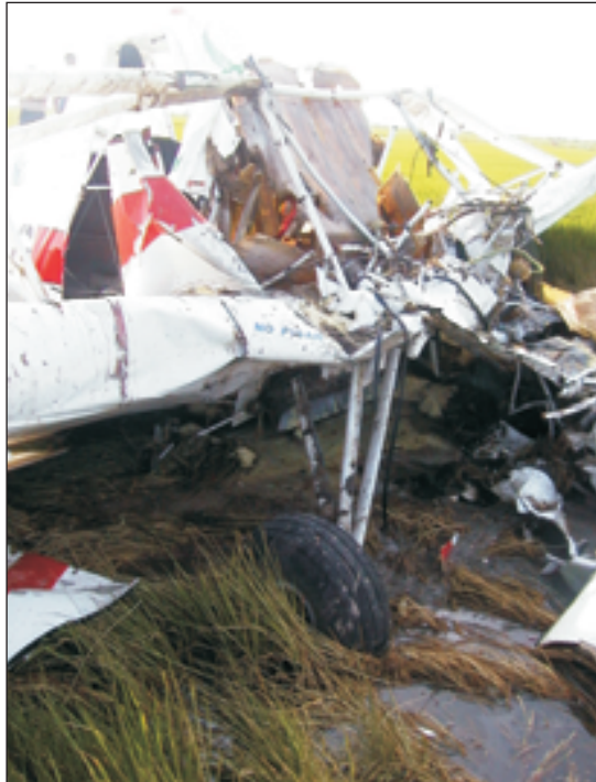
Foto 2. Daños en el tren principal
