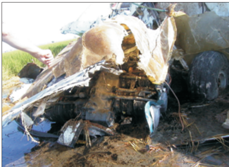
Foto 3. Daños en el motor y hélice
