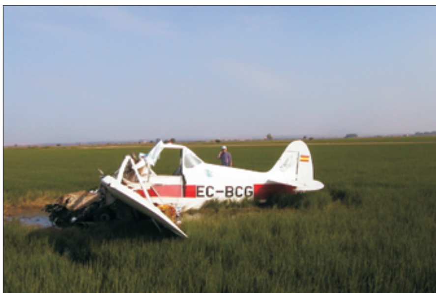
Foto 1. Tanques destruidos y plano girado
