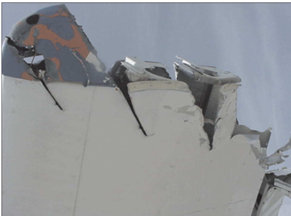
Vistas del extradós del plano izquierdo de la Cessna 152 (EC-FPQ) (el borde de salida está hacia la derecha de la foto). Se aprecian tres cortes claros en el revestimiento y lo que parece ser un corte final que daña también el alerón
