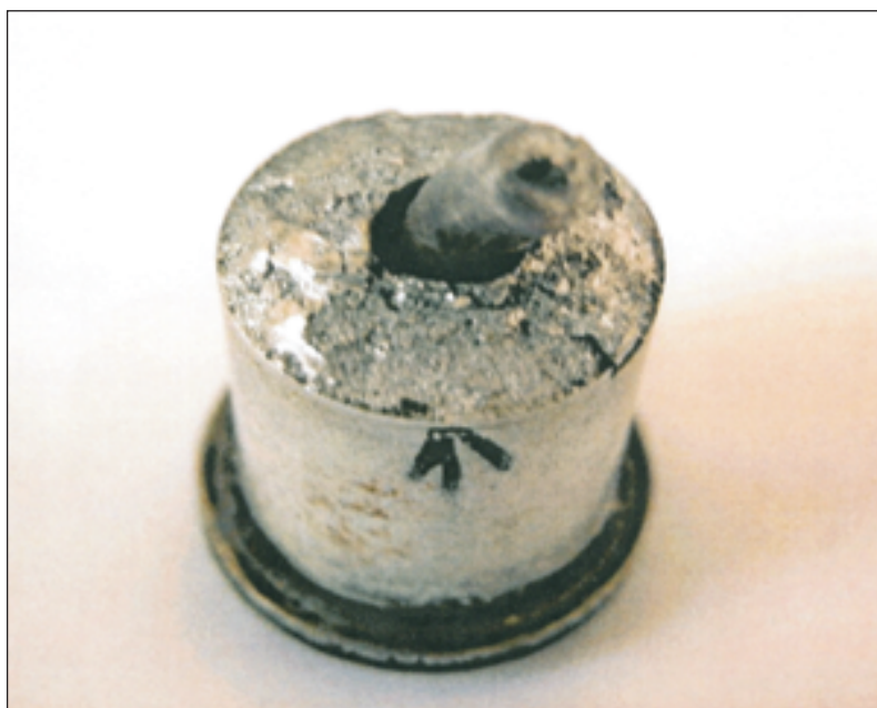
Foto 1. Detalle de la rotura del tetón
