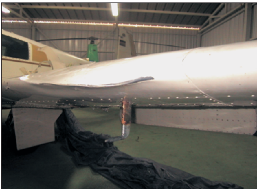
Foto 2. Daños ocasionados en el ala izquierda de la aeronave D-EIGB. Detalle del borde de ataque
