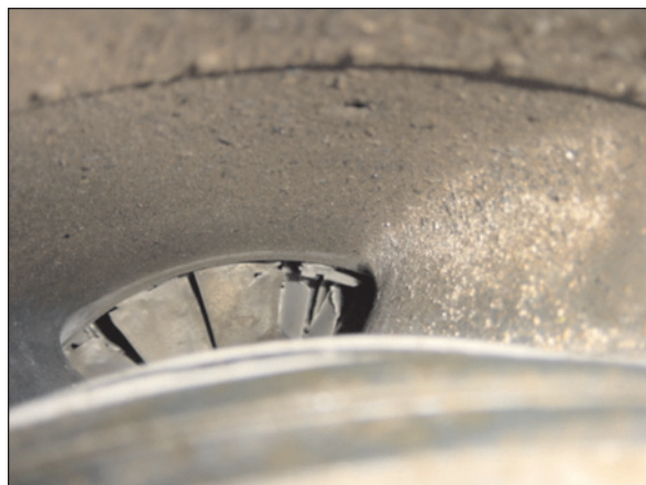
Foto 2. Daños por ingestión en el motor
