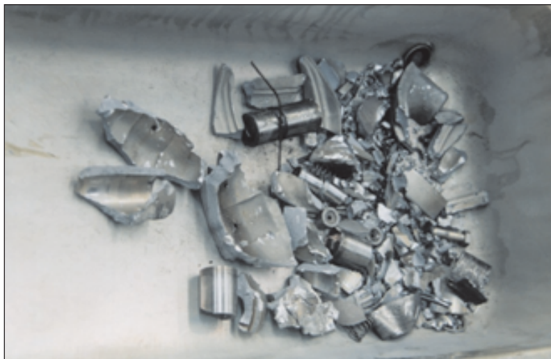
Figura 1. Restos encontrados en el cárter de aceite.
