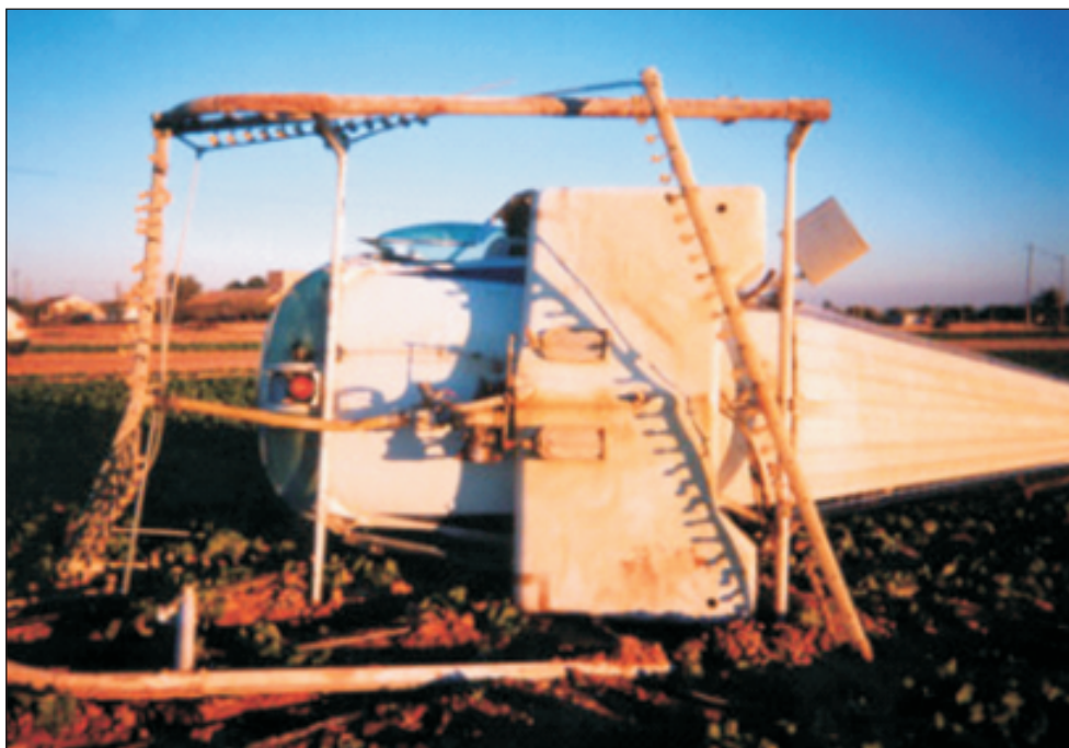
Foto 2. Patín y pértigas rotas
