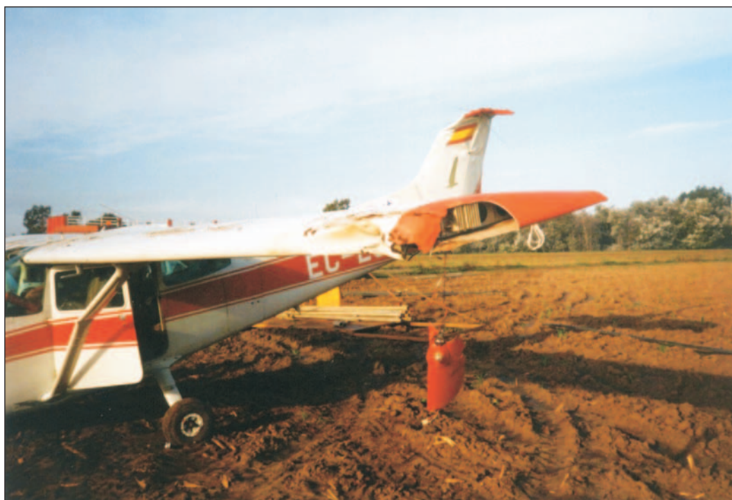
Foto 2. Daños en el plano izquierdo y empenaje vertical
