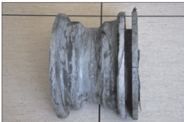
Marcas en la garganta de la llanta.
