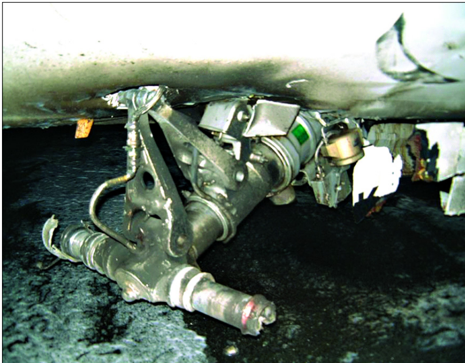
Detalle: pata de morro colapsada
