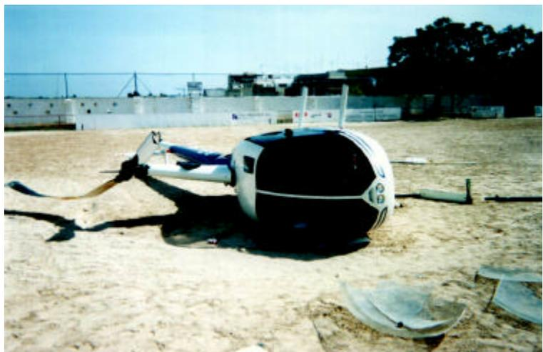
En el lugar del accidente se encontró que el paso colectivo estaba en la posición de paso máximo.
