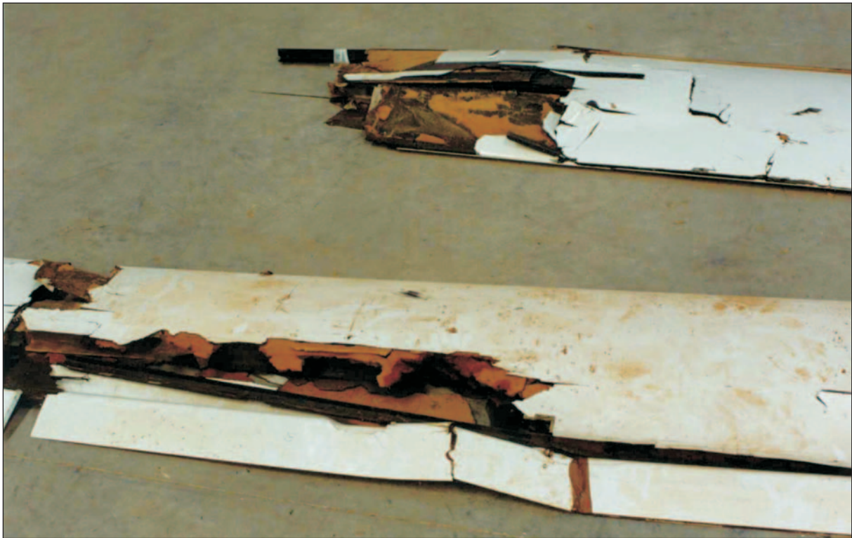
Roturas exteriores del ala. Extradós
