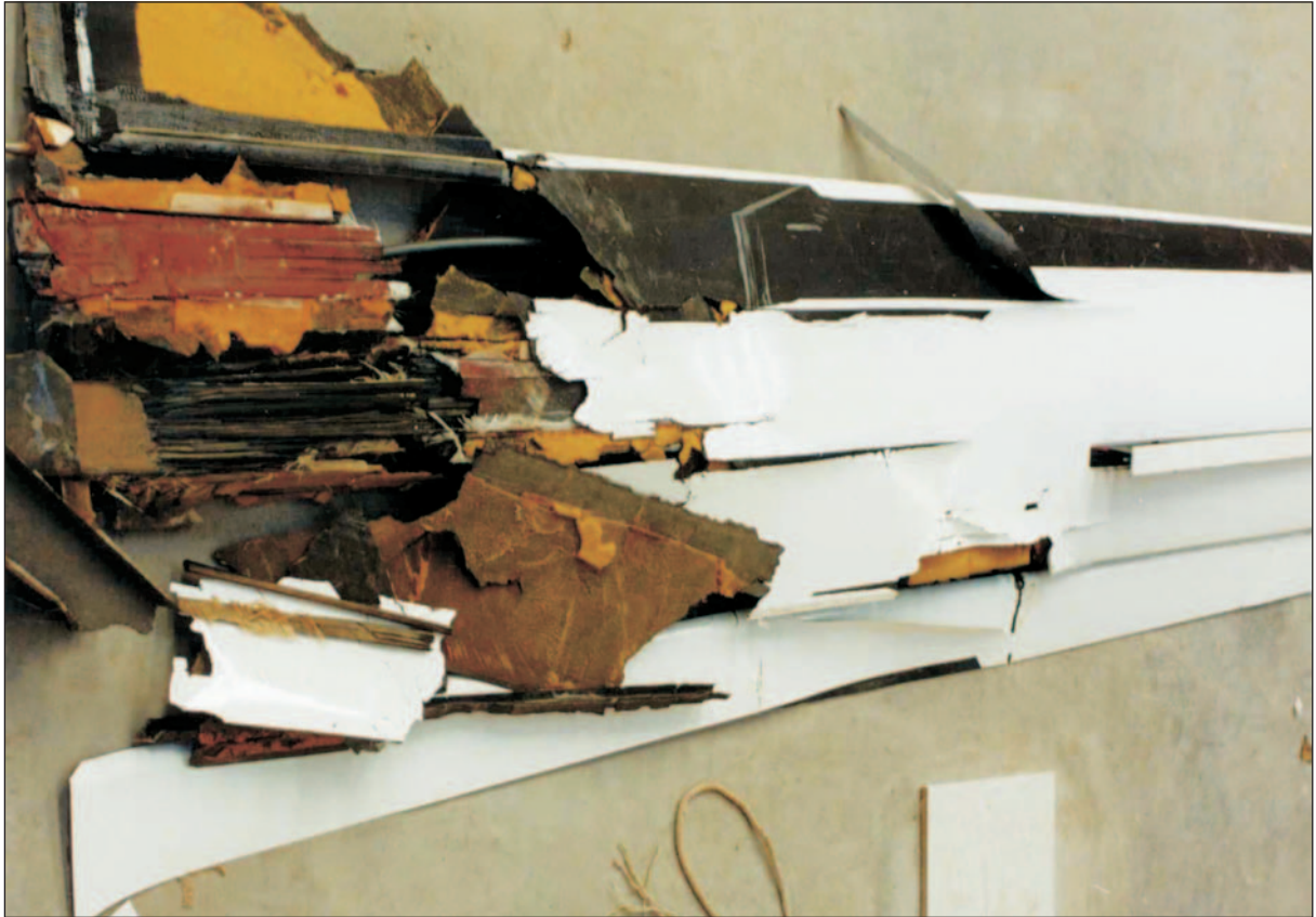
Rotura interior del ala derecha. Extradós
