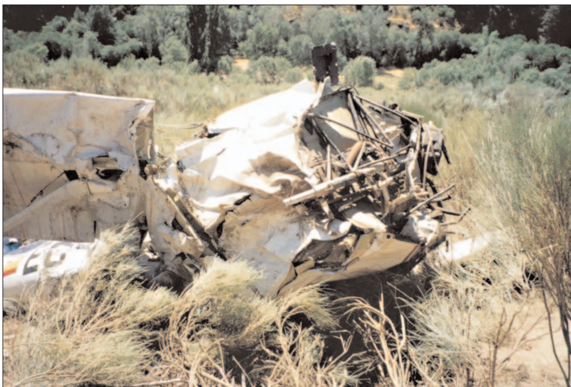
Foto 2. Vista del encastre del plano derecho y la bancada del motor
