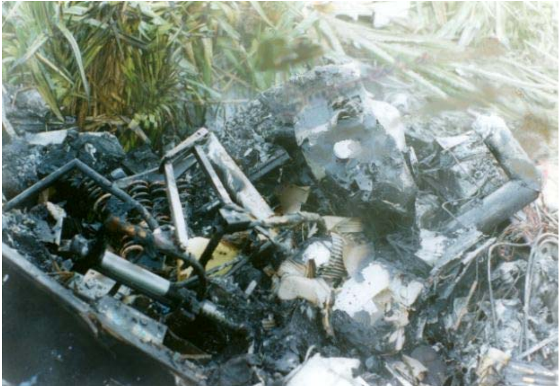
Foto 7. Detalle del pedestal central. Mandos de tren y compensadores de alabeo y guiñada.
